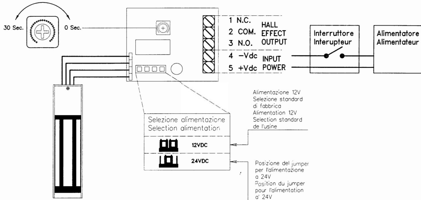
Modulo di controllo per elettromagneti Art. 13700 TD
