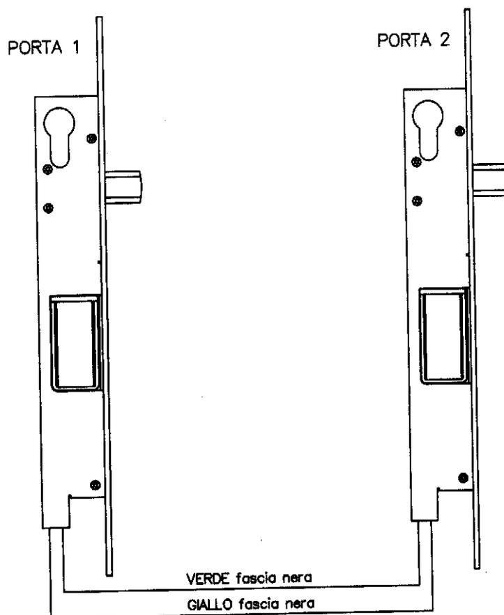
L'elettronica interna dell'elettropistone è in grado di gestire direttamente il funzionamento in interblocco di 2 (o più porte) secondo lo schema di collegamento sopra riportato .
