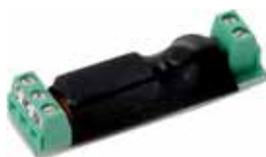
**Utilisation:** Ce circuit permet de transformer le contact à 12 Vca pour l'activation des électroserrures traditionnelles en provenance du système de l'interphone, au contact propre N.O. nécessaire pour l'activation de la commande d'ouverture de l'électroverrou.
