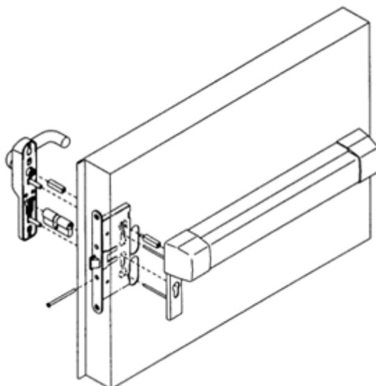
**Aplicación con cerradura para puertas cortafuegos de cristal con distancia entre ejes de 92 mm y barra antipánico de empotrar**
