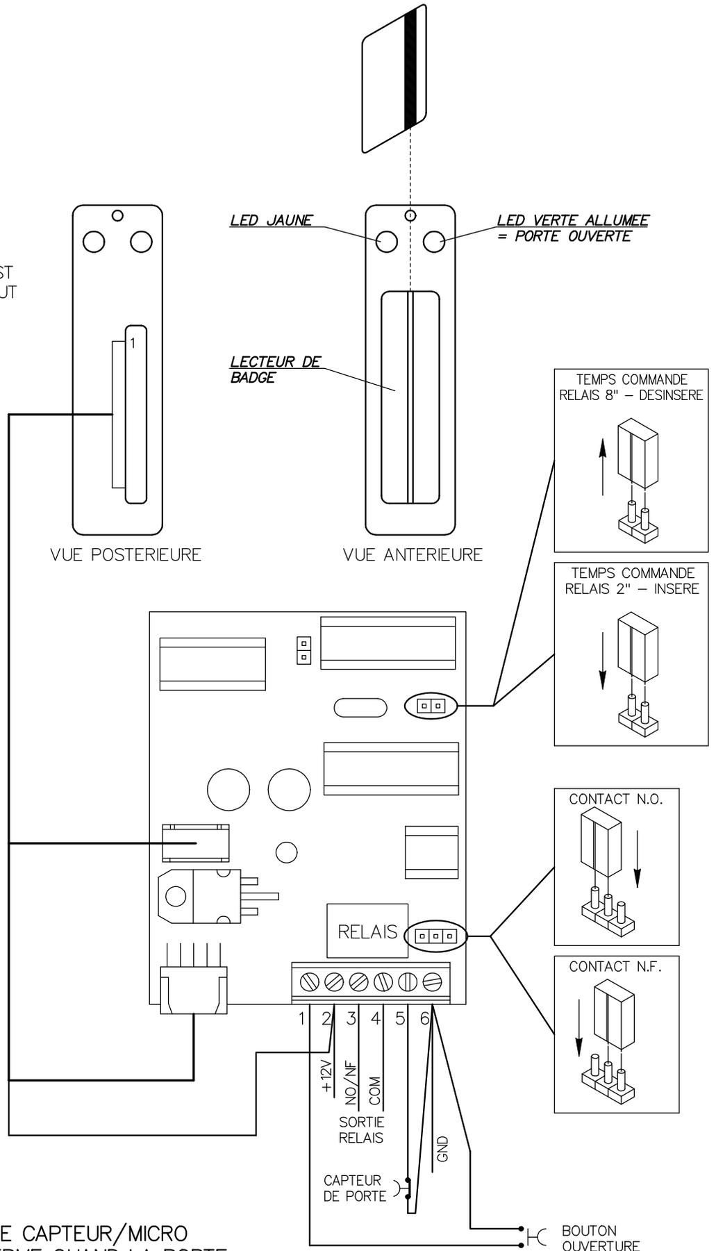
BRANCHER AU CIRCUIT LE CAPTEUR/MICRO
